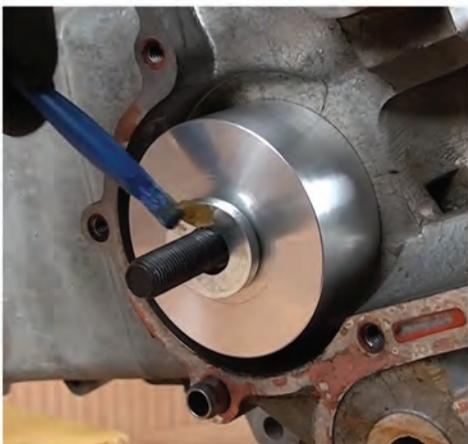
4. ...la cage à aiguilles, de la graisse et la 2ième rondelle.
