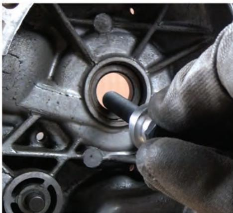
2. Mettre en place l'arrache roulement sur le carter.
