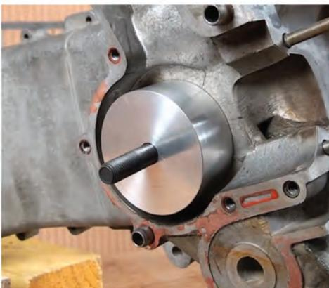
3. Insérer la première rondelle sur la vis, puis appliquer de la graisse épaisse...
