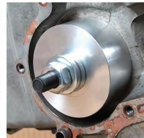
6. Chauffer le logement du roulement à l'aide d'un décapeur thermique ou d'une lampe à souder, pendant +/- 1 minute afin de le dilater. Cela permet de sortir le roulement sans endommager le carter.
